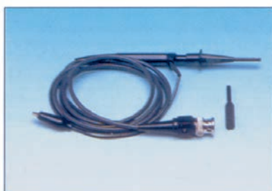
شکل ۱-۸۵- کاربرد کابل کواکسیال در پراب اسپلوسکوپ
