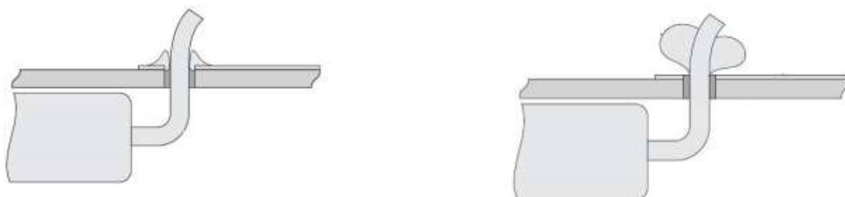
شکل ۳-۳- لچیم کاری نامناسب
