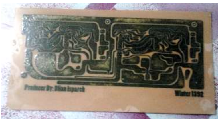
شکل ۲-۱۱ کیت آمپلی فایر بعد از اسید کاری (پاک شدن مس های اضافی)
